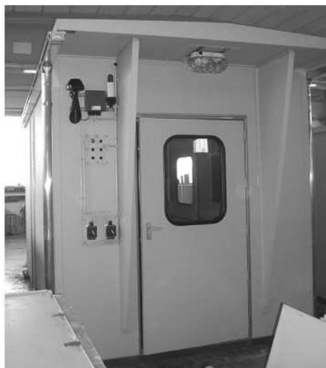
Энергосберегающий шельтер с системой климат-контроля
